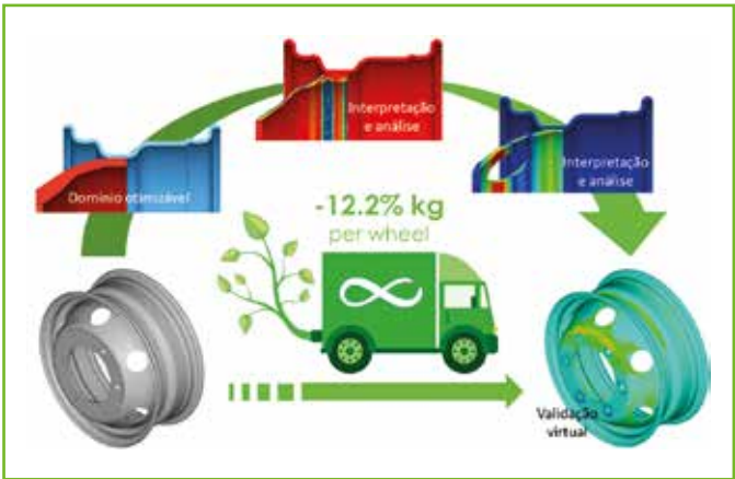
Figura 1 – Processo de otimização para rodas de aço (CAE)
